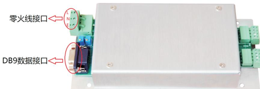
注意：图中L N E（对应零线火线地线），注意不要接错！！
