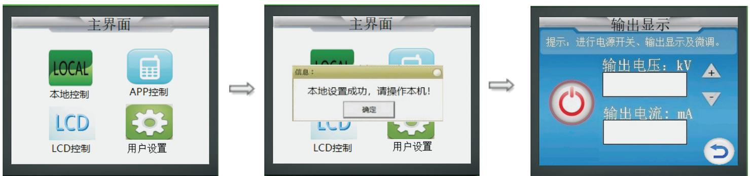
② 调节电源面板电位器进行电源电压、电流的设定，电源输出值在上图【输出显示】界面显示。
