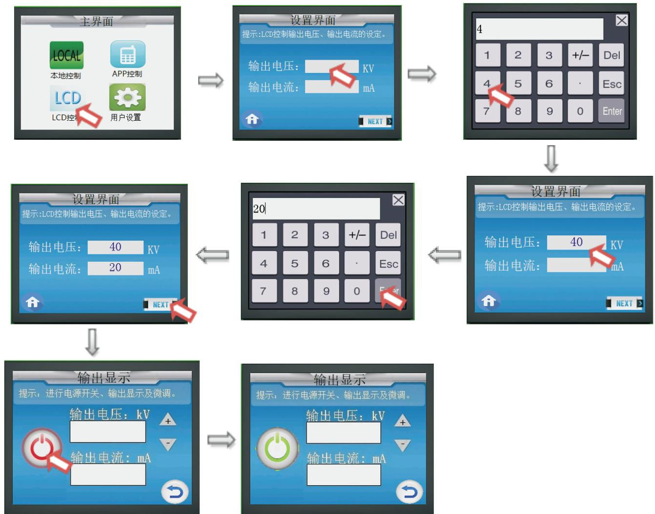
注:根据电源规格参数进行输出电压,输出电流设置在使用LCD模式之前, 请将本地的电位器接逆时针方向拧到底
